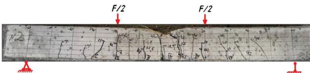
Рисунок 5 – Схема разрушения опытной балки при статическом нагружении.
