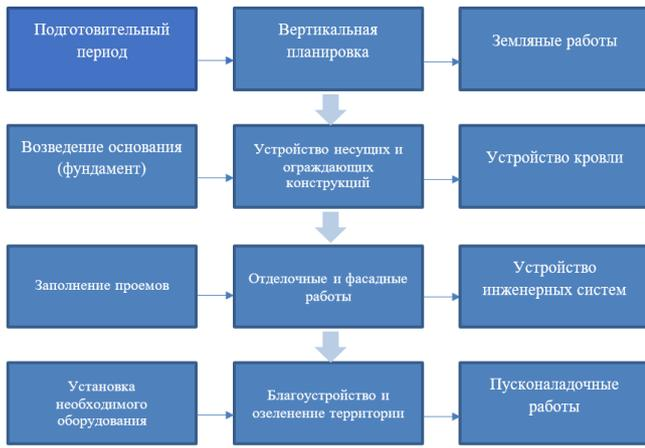
Рисунок 1. Технологическая последовательность работ
