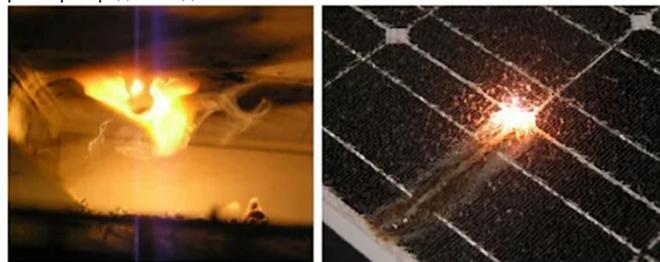
Рис. 1 - Эффекты индуцированной электрической дуги через перегородки соединителей ячеек
