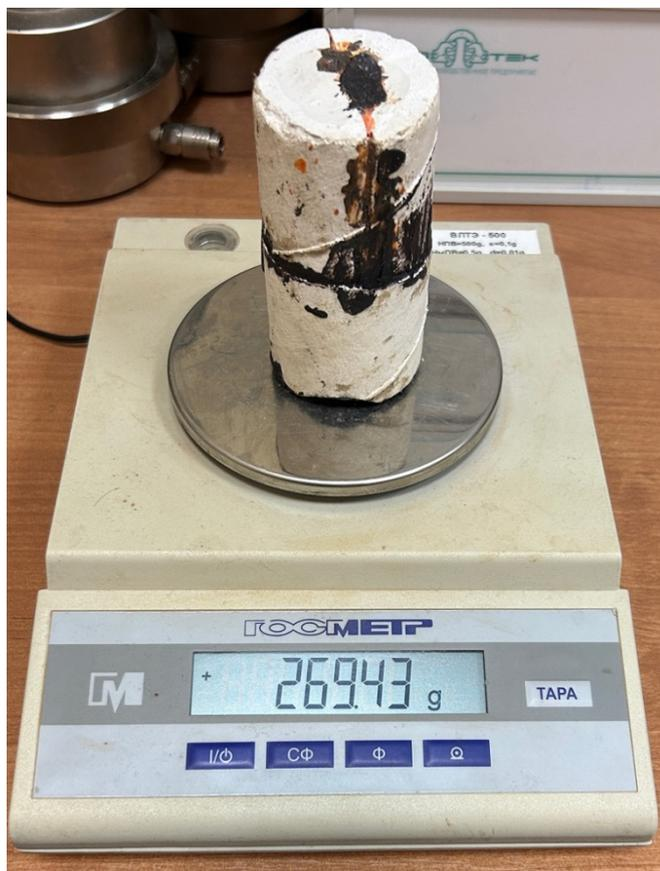
Рис.1. Распиленный образец перед опытом.
