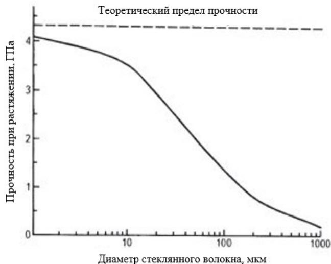
Рис. 3. Зависимость прочности при растяжении от диаметра стеклянных волокон
